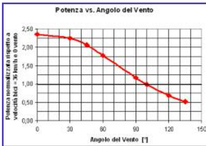
Fig.5.2 – Potenza in funzione dell'angolo del vento. Velocità del vento=12km/h. Valori normalizzati rispetto a velocità di avanzamento=36 km/h e assenza di vento.
