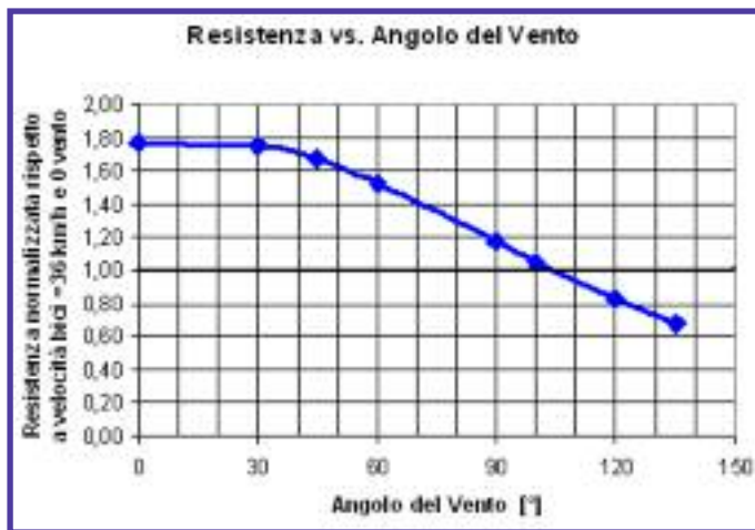
Fig.5.1 – Resistenza in funzione dell'angolo del vento. Velocità vento=12km/h. Valori normalizzati rispetto a velocità di avanzamento =36 km/h e assenza di vento.
