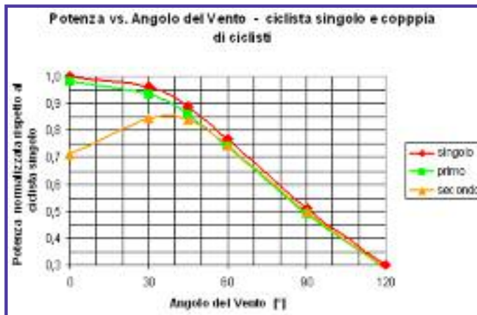
Fig.7.2 – Potenza in funzione dell’angolo del vento per coppia di ciclisti.
