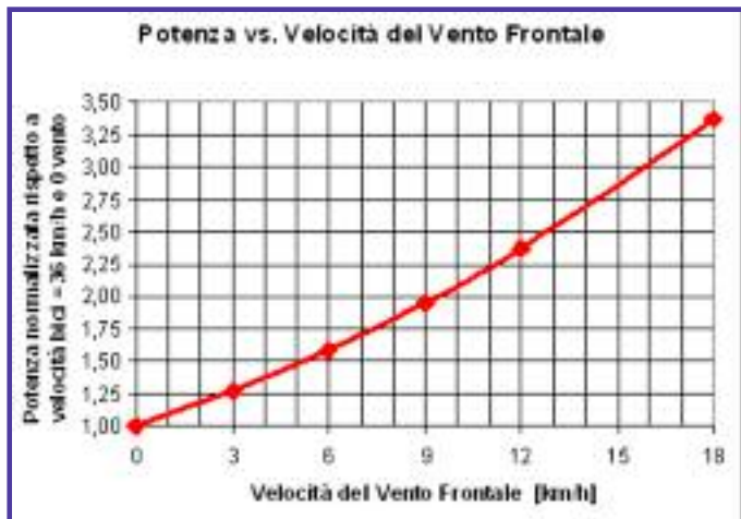
Fig.4.2 – Potenza in funzione della velocità del vento frontale. Valori normalizzati rispetto a velocità di avanzamento =36 km/h e assenza di vento.
