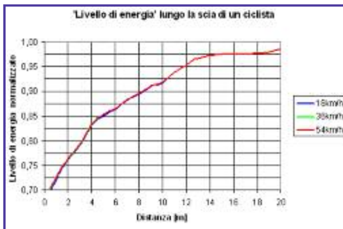
Fig.6.1 – "Livello di energia" per alcune distanze lungo la scia del manichino. I valori sono normalizzati rispetto alla posizione a monte. Valori più bassi indicano una minore resistenza all'avanzamento di un corpo. Si nota la non simmetria della scia, dovuta alla posizione non simmetrica del manichino.
